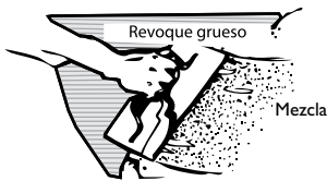
Figura 5 Aplique la mezcla con un fratacho.
