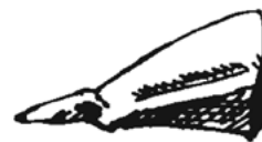
Manga para enlechado
